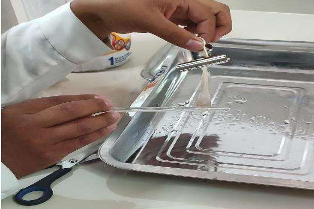
**Figura 22** Secado de la muestra para el análisis de finura
