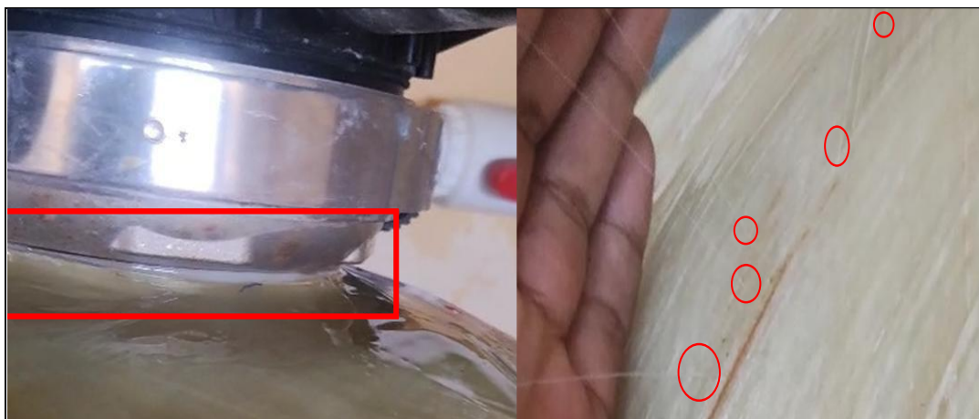
Tanques de filtración multimedia – Imagen de los filtros de alta presión, uno de ellos con fisura estructural documentada.
