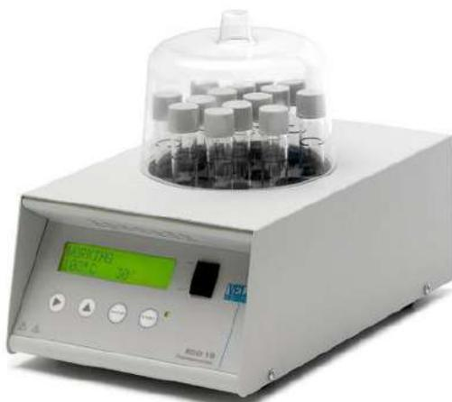
**ESTE TERMORREACTOR** de 16 posiciones (14 para tubos de 16 mm de diámetro externo y 2 para tubos de 22 mm de diámetro externo) ha sido diseñado para determinaciones de DQO, fósforo total, cromo total, y otros análisis por descomposición. Permite la realización de una serie de análisis, obteniendo resultados con la máxima precisión. La electrónica empleada permite programar tiempos y temperaturas, en rangos muy amplios, con alta precisión y repetitividad.
